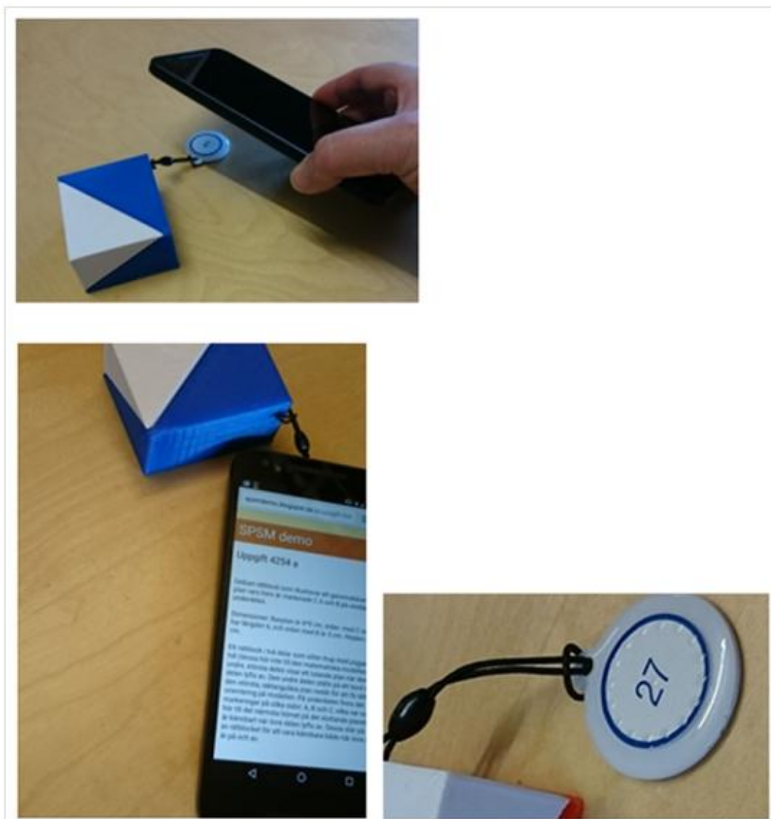
Figur 22. NFC-tag i form av en rund bricka fäst vid rättblock (ovan vänster). Förstoring av NFC-taggen (nedan vänster). När man lägger en (Android-)telefon ovanpå taggen startas automatiskt webbläsaren och en sida med information om modellen visas eller läses upp (höger).
