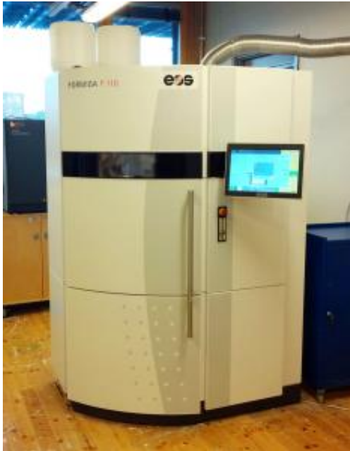
Figur 6. SLS-skrivare av märket Formiga på Designvetenskaper, Lunds universitet.
