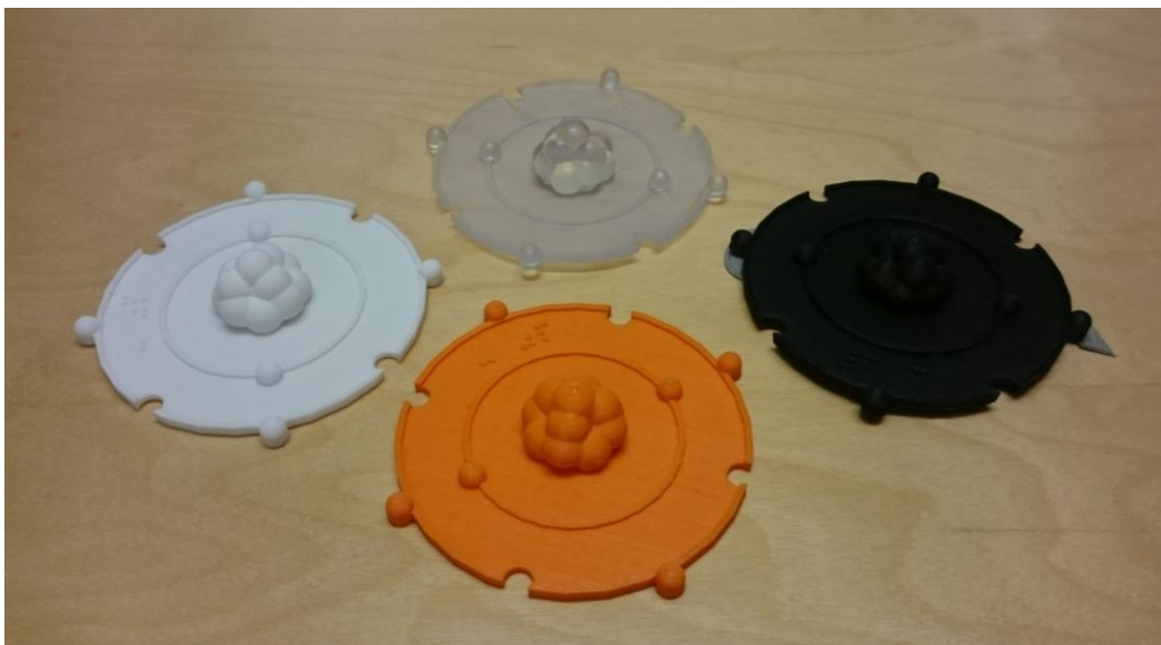
Figur 10. Fyra kolutomer utskrivna på olika skrivare. Orange: Ultimaker (FFF) ( https://ultimaker.com ), svart: Rapide3D (FFF) ( http://www.3dscanandprint.com ), genomskinlig: Formlabs form1+ (resin, flytande harts som stelnar vid belysning med högintensivt ljus) ( http://formlabs.com ), vit: Formiga (SLS) ( http://www.eos.info/systems_solutions/plastic/systems_equipment/formiga_p_110 ).
