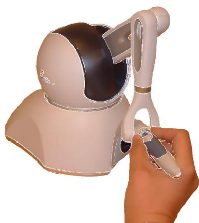
Figur 56. Haptisk penna, Phantom OMNI. Handen håller i pennan och motorerna i basen skapar en motkraft. Det känns då som att man petar på ett verkligt objekt.
