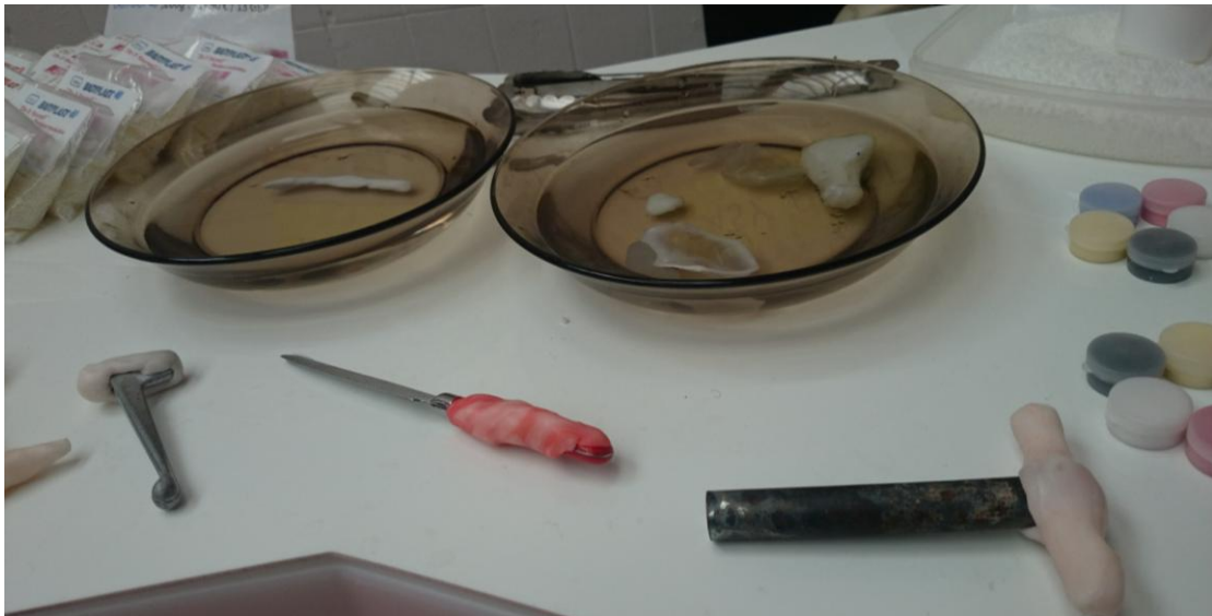
Figur 52. Två vattenbad, ett varmt och ett kallt, för att arbeta med plasten. I förgrunden några handtag av plast som formats kring t.ex. en brevkniv.
