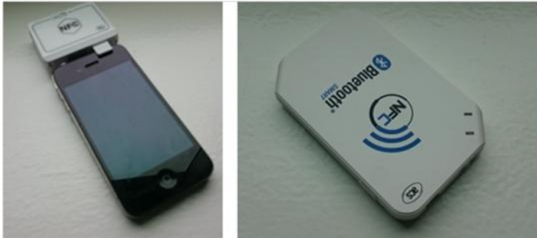
Figur 23. NFC-läsare kopplad till en iPhone (det finns smidiga skal som är mindre skrymmande) samt en lös NFC-läsare som med hjälp av Bluetooth kan skicka information till en läsplatta eller dator.
