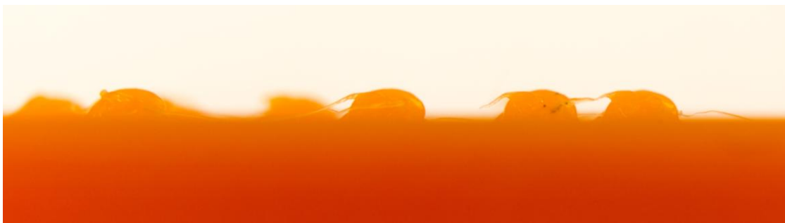
Figur 28. Vass utskrift av punktskrift av PLA-plast i en FFF-skrivare, utskriven på toppen, d.v.s. vågrätt. Platen spritsas ut (se figur 2), och när utskriften avslutas på varje punkt blir det en tunn, vass topp av plast. Här syns i en förstorad bild att det blir plastrester på toppen av punkterna.
