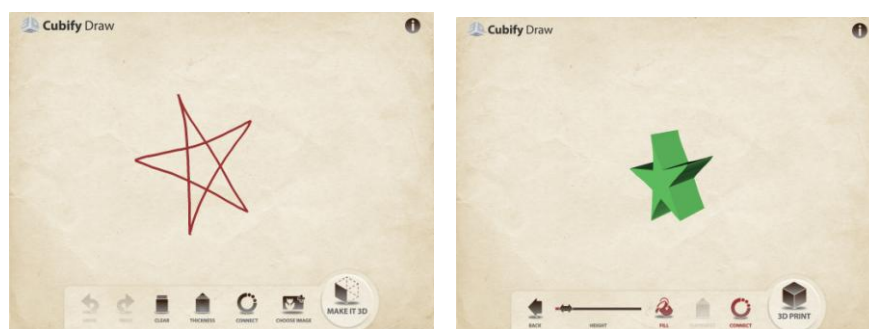
Figur 58. Cubify Draw, två skärmbilder. Vänster: En stjärna som är ritad med streck. Höger: Stjärnan ifylld och tjock, så att man kan skriva ut den som en stjärnformad platta. Plattan kan göras olika tjock med en inställning.
